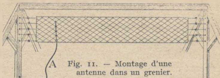
Fig. 11. — Montage d'une antenne dans un grenier.
